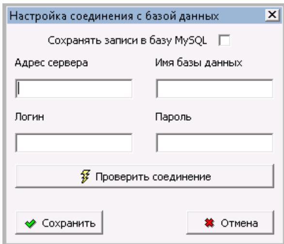
Если опция включена, то в указанной базе MySQL таблицы `anviz_devices` и `anviz_logs` будут созданы автоматически при клике на «Проверить соединение».
