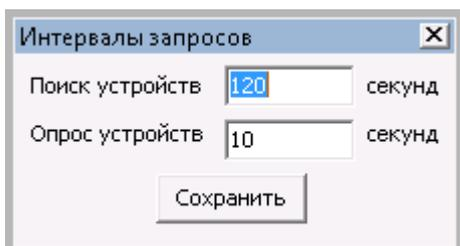
Поиск устройств и Опрос устройств (получение логов) не могут выполняться одновременно. При поиске устройств выполняется проверка обращений устройств в режиме Клиент и проверка доступности по IP адресу устройств в режиме Сервер.
